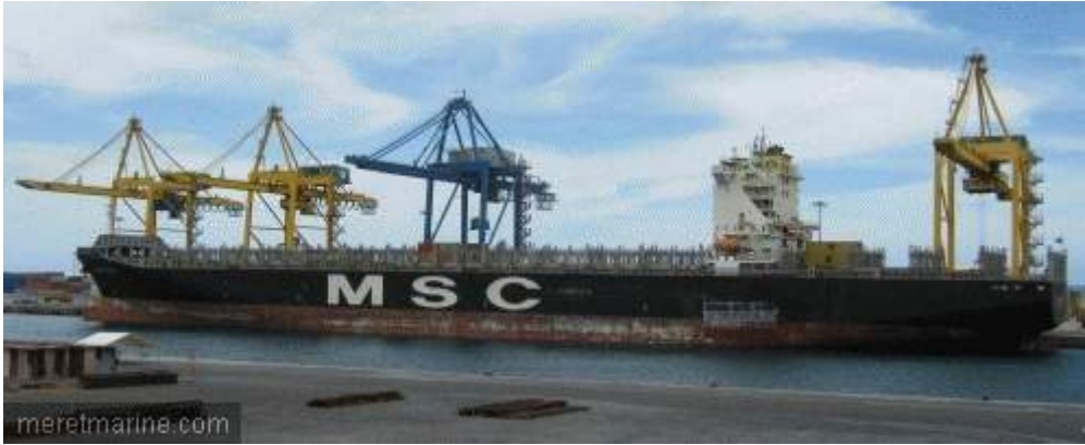
O Navio MS Laura em Port Réunion, com 300m comprimento, 40m de boca e 6.732 TEU's
