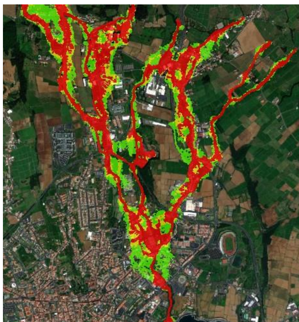
Figura 7.9 – Detalhe das zonas mais vulneráveis a cheias e inundações e de intervenção prioritária – Ribeira de São Bento
